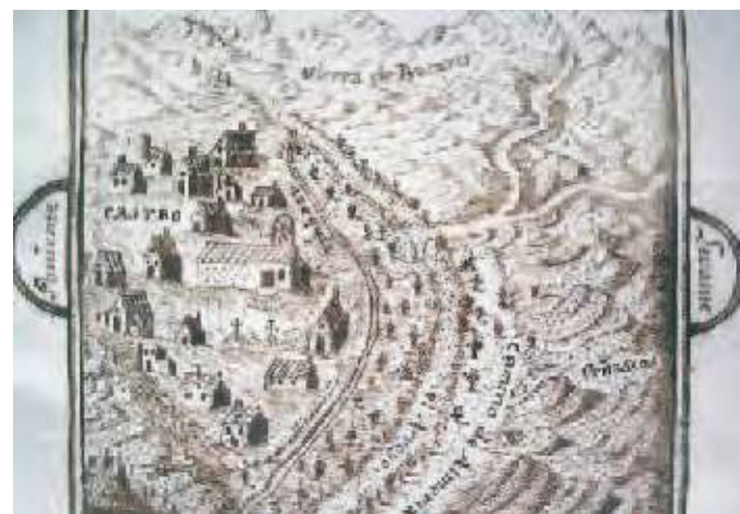
9.44 El sistema de riego que muestra el dibujo del Catastro de Ensenada de Castro era el heredado de la edad media: una simple presa de derivación toma el agua del pequeño arroyo y la lleva a una acequia que permite regar los bancales situados junto al mismo
