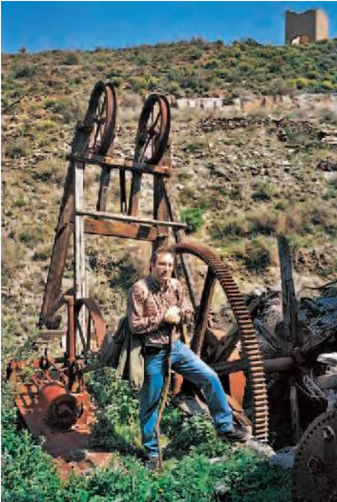
9.51 Esta máquina de vapor descubierta recientemente en Sierra Almagrera es la más antigua de las que se conservan en España dedicadas a la minería y una de las más antiguas de Europa. Aunque construida en Inglaterra, fue diseñada y montada in situ por el ingeniero belga Paul Colson, que comenzó a trabajar en las minas del Levante almeriense hacia 1855. Colson diseñó motores económicos, robustos y adaptados a las condiciones del terreno. El artefacto fue descubierto y estudiado por Diego Collado Fernández y el profesor Andrés Sánchez Picón, que aparece junto a la máquina en la fotografía
